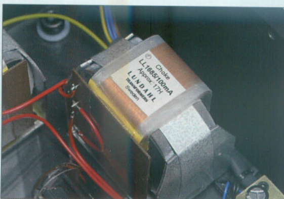
Τα δύο choke της Lundhal είναι μέρος του τροφοδοτικού του Spheris
