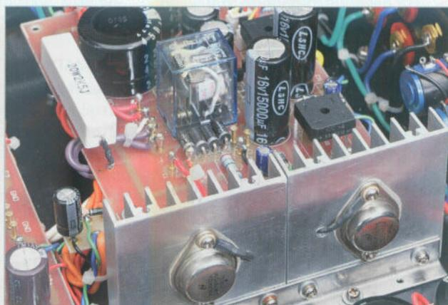
Zwei kräftige integrierte Regler liefern die Heizspannungen der insgesamt vier Eingangsröhren
