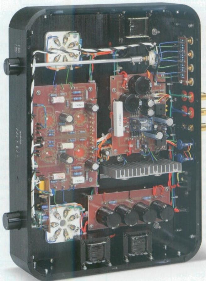
Ganz unten zwei der Siebspulen des Netzteils, links die Verstärkerplatine. Man beachte die riesigen Keramikfassungen der beiden 6C33
