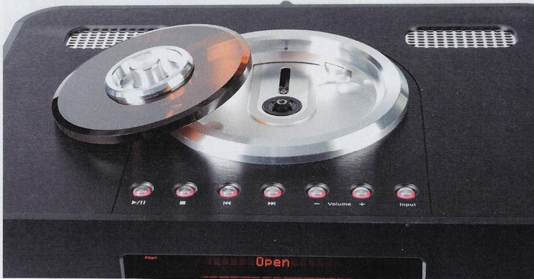
Der dicke Laufwerksdeckel aus rauchfarbenem Acryl liegt auf dem Alurand auf, stellt aber gleichzeitig eine CD-Klemme dar. Zwei Griffmulden sorgen dafür, dass die Disc leicht entnehmbar ist.
