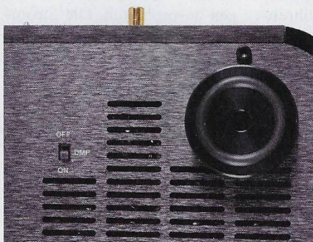
Ein gut versteckter Schiebeschalter reduziert den Ausgangspegel um sechs Dezibel, falls bei sehr empfindlichen End- oder Vollverstärkern Rauschprobleme auftreten sollten.
