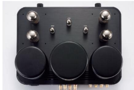
Scorpioを真上から見たところ。使用真空管はKT88×4、12AU7×3となっていて、配置は写真のようになっている。真空管はSpirit IIIと同様に、すべて特別なテスターでマッチングが図られている
