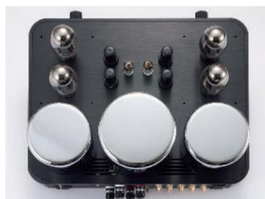
Spirit IIIを真上から見たところ。使用真空管はKT150×4、12AU7×2、6SJ7×4となっていて、配置は写真のようになっている。ちなみに真空管はすべて特別なチューブテスターで厳密なマッチングが図られている
