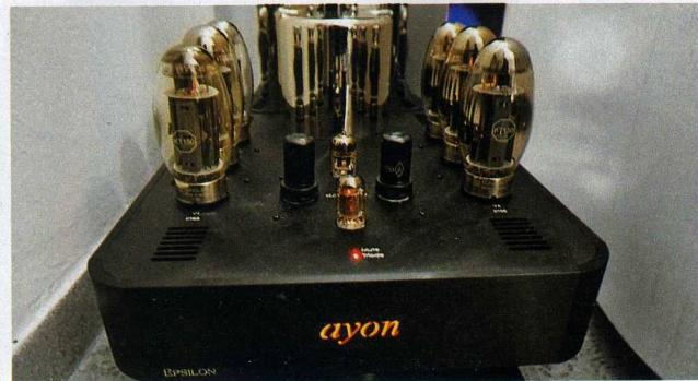
μπλόκ στηρίζεται σε δύο μεγάλους μετασχηματιστές τροφοδοσίας και σε φιλτράρισμα με τρία choke και εκτενή χωρητικότητά για τις τάσεις πειτουργίας. Τόσοι αυτοί όσο και ο κεντρικός τοποθετημένος μετασχηματιστής εξόδου βρίσκονται σε επινικεφωμένους μεταθλικούς θαλάμους και είναι εμποτισμένοι σε αποσβετικό υψηλό για μείωση των κραδασμών.
