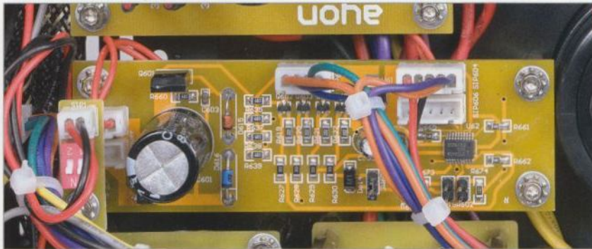
Röhre in der Jetztzeit: Ayon schreckt vor SMD-Helferlein keineswegs zurück – hier offensichtlich in der Ruhestromüberwachung der vier 6C33
