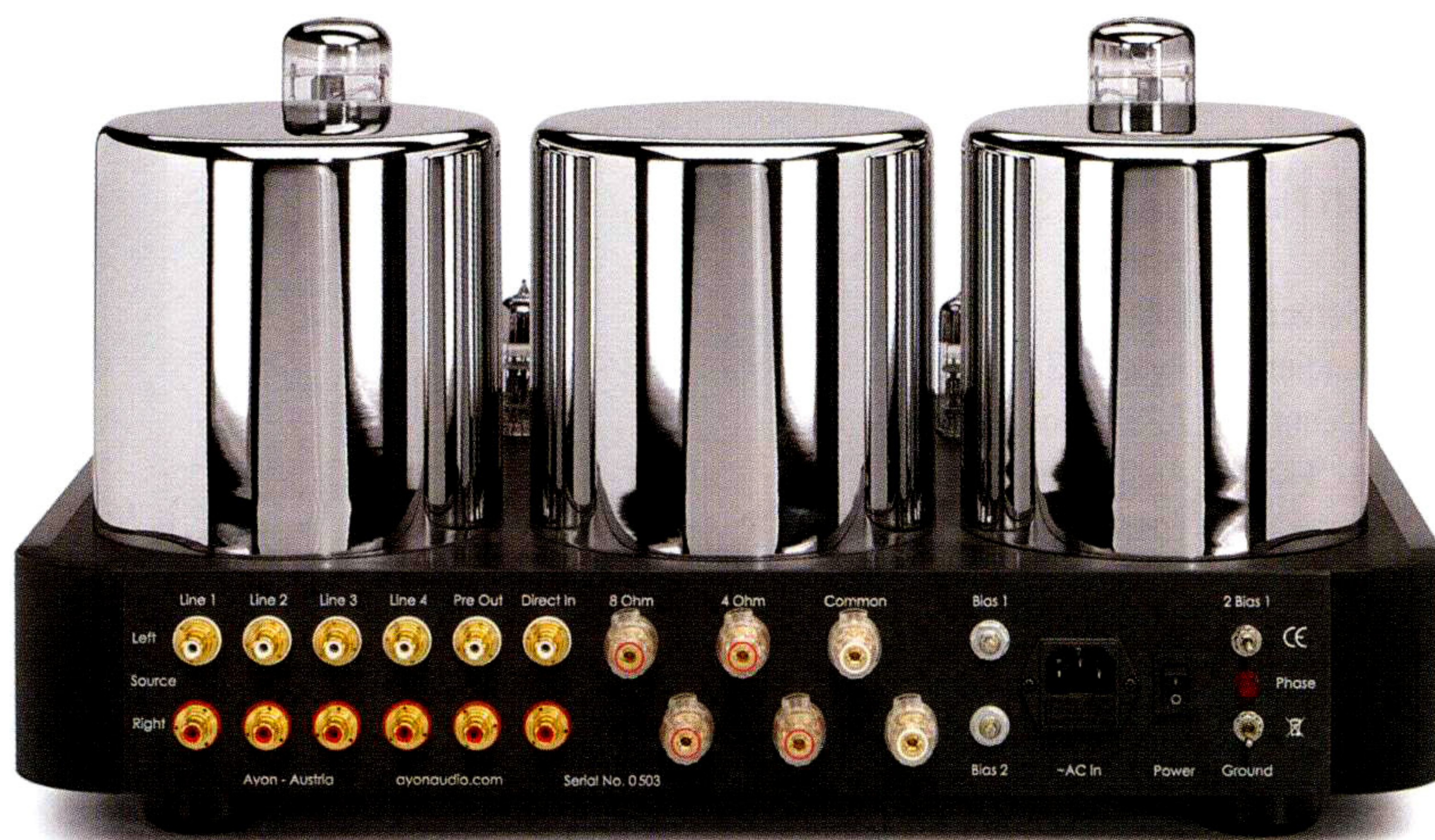
„Ground Lift“, Netzphasen-Kontrolle und die auch für Laien wirklich einfache Bias-Justage findet man gleich neben dem Netzschalter
